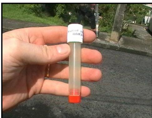
Les tubes sont posés à environ 2 mètres du sol, essentiellement pour des raisons de vandalisme, sur des supports (lampadaire, poteau...) et restant représentative de l'air respirable. Les tubes sont posés sur des supports en bois qui sont fixés au poteau à l'aide de collier de serrage.
